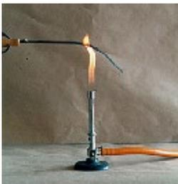
Abb. 30.2: Bimetallthermometer beim Erwärmen
