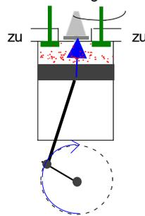
Abb. 53.2: Verdichtungstakt
