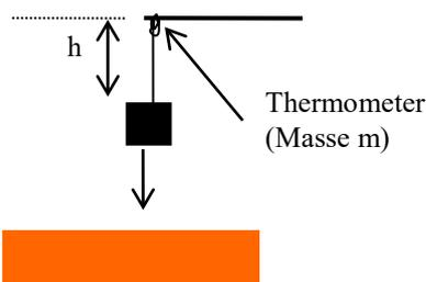
Versuchsaufbau zur Bestimmung der Formel  $\Delta E_i = c m \Delta\vartheta$
