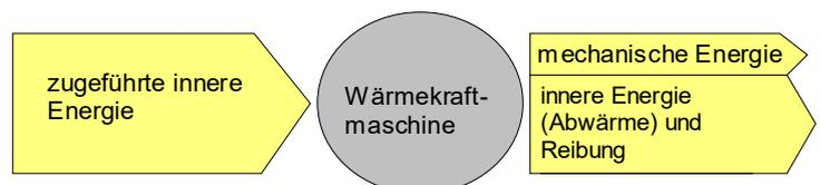
In diesem Zusammenhang ist es wichtig zu erkennen, dass jede Wärmekraftmaschine, um periodisch arbeiten zu können, innere Energie in Form von Abwärme abgibt. Bei dem von uns gewählten Beispiel wäre ohne diese Form der Energieabgabe das Zurückdrängen des Kolbens in seine ursprüngliche Lage nur unter der Aufwendung von Arbeit möglich. Die dazu aufzuwendende Arbeit ist aber genau so groß wie die Arbeit, die zuvor von dem Gas verrichtet wurde. In der Summe stünde uns also keine Arbeit zur Verfügung.
