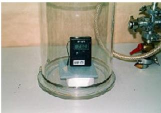
Abb. 38.3: Nachweis der Wärmestrahlung im Vakuum
