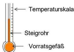
Abb. 28.3: Flüssigkeitsthermometer
