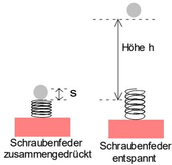
Abb. 11.1: Nachprüfen der Formel für die Spannenergie
