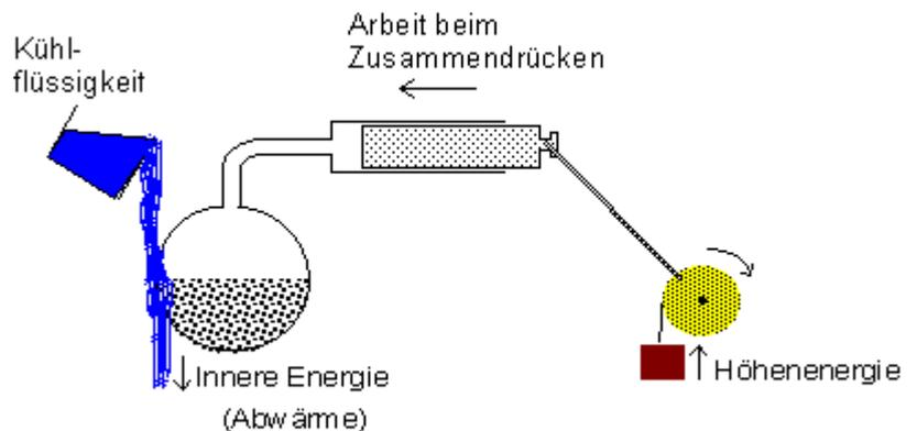
Wenn man das Wasser im Glaskolben abkühlt, wird ihm Wärme entzogen. Dadurch kondensiert der Wasserdampf, so dass in dem Glaskolben und dem Kolbenprober ein Unterdruck entsteht. Daher schiebt der Atmosphärendruck den Kolben wieder nach links. Über eine feste Rolle wird das Massenstück wiederum hochgehoben. Dabei wird Hubarbeit verrichtet.
