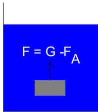
Abb. 20.1: Heben eines Körpers in einer Flüssigkeit
