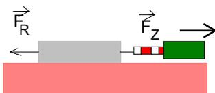
Abb. 4.1: Zusammenhang von Reibungskraft  $F_R$  und Zugkraft  $F_Z$ .
