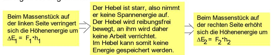
Wie das Energieflussdiagramm zeigt, kann der Hebel keine Energie speichern. Somit gilt aufgrund des Energieerhaltungssatzes:
