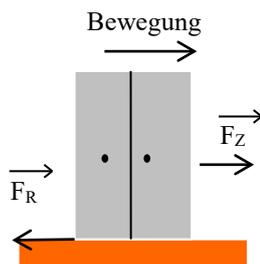
Abb. 3.2: Gleitreibung bei dem, mit konstanter Geschwindigkeit gezogenen Schrank.
