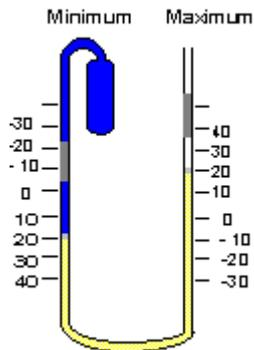
Abb. 30.1: Maximum-Minimum-Thermometer
