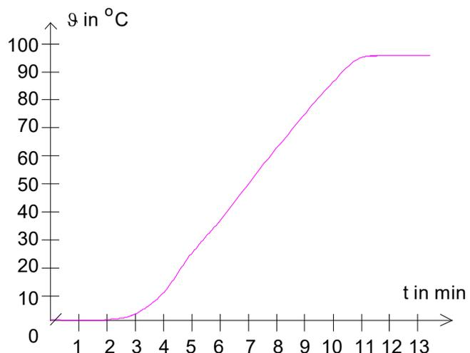
Das t- $\vartheta$ -Diagramm zeigt, dass bei  $0^{\circ}\text{C}$  (Schmelztemperatur von Wasser) und bei  $96^{\circ}\text{C}$  (Siedetemperatur von Wasser) die Temperatur für einige Zeit konstant bleibt, obwohl die Heizplatte kontinuierlich Wärme an das Eis bzw. Wasser abgibt. Um dieses Phänomen zu erklären betrachten wir die Änderung der Aggregatzustände und der damit verbundenen energetischen Prozesse mit Hilfe des Teilchenmodells.
