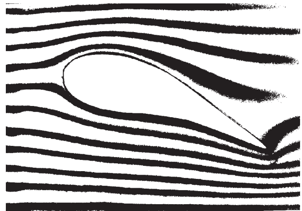
Abb. 11: Umströmung eines tragflächenförmigen Lochs mit der Velourpapier-Methode. Das Bild gleicht einer Umströmung einer Tragfläche ohne Zirkulation.
