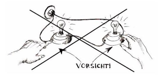
Der Übergangswiderstand an den beiden Kontaktstellen (Hand/Metall) beträgt jeweils 3 K .Q. Der Widerstand durch den Körper beträgt  $1,5~\mathrm{K}\Omega$ .
