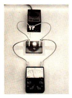
Das Voltmeter wird parallel zum Stromkreis geschaltet
