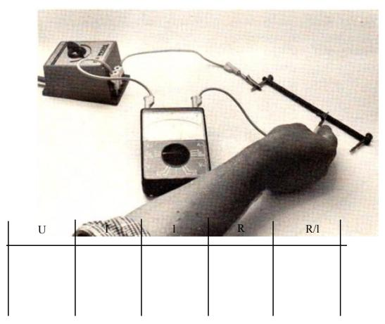
Kennt man von einem Material den Widerstand eines Drahtes von der Länge 1 = 1 m und den Querschnitt q = 1 mm<sup>2</sup>, so kann der Widerstand eines Drahtes mit beliebigen Abmessungen berechnet werden.
