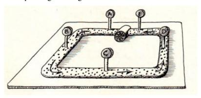
Die obere Abbildung zeigt einen geschlossenen Wasserkreis, der gleichmäßig mit einem Stoff gefüllt ist. Dieser Stoff läßt das Wasser zwar durch, behindert aber das Fließen sehr stark.
