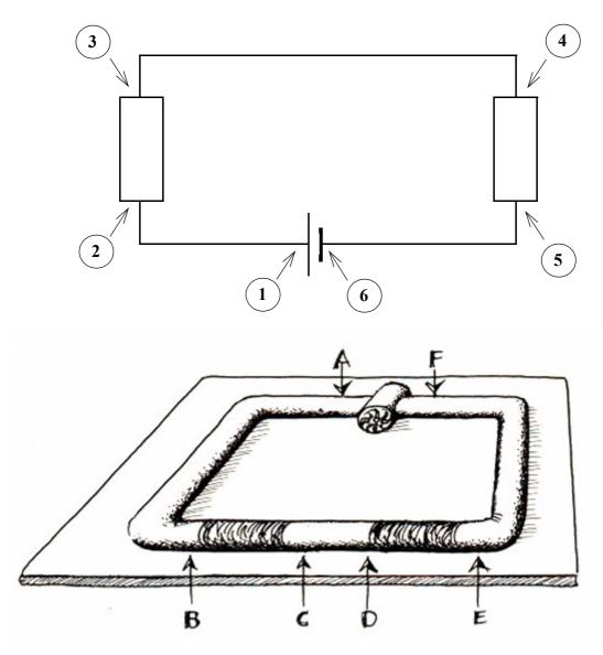
Welcher Druckunterschied im Wasserkreis entspricht welcher Spannung im Stromkreis?
