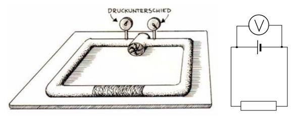
In einem elektrischen Stromkreis (oder an einer Energiequelle) tritt eine Spannung immer nur zwischen zwei Punkten auf.
