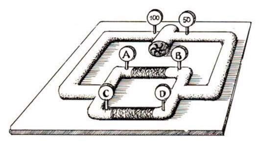
Wie groß ist der Druck an den verschiedenen Meßstellen? Wie groß ist der Druckunterschied zwischen den Meßstellen A/B und C/D?
