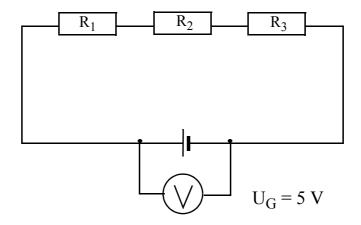
Mit diesen Angaben könnt ihr sowohl den gesamten Strom als auch die Teilspannungen berechnen, die an den einzelnen Widerständen auftreten.
