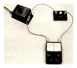
Das Amperemeter wird in den Stromkreis geschaltet
