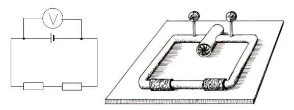
Im elektrischen Stromkreis ist die Spannung die Ursache für das Fließen des elektrischen Stromes (der Antrieb). Im Wasserkreis ist der Druckunterschied vor und hinter der Pumpe für das Fließen des Wassers verantwortlich.
