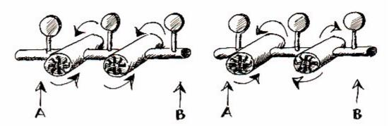
Wie groß ist der Druckunterschied zwischen A und B, wenn jede Pumpe einen Druckunterschied von 5 Einheiten bewirkt?
