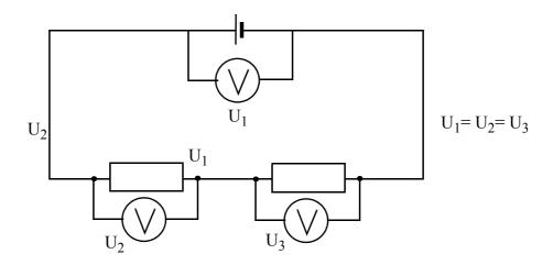
Dieser Zusammenhang gilt in gleicher Form für den Druckunterschied in einem Wasserkreis mit mehreren in Reihe geschalteten Widerständen. Auch hier ist die Summe der einzelnen Druckunterschiede gleich dem gesamten von der Pumpe erzeugten Druckunterschied.
