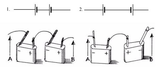
Probiert beide Möglichkeiten aus und meßt jedesmal die Spannung zwischen den Ausgängen A und B.
