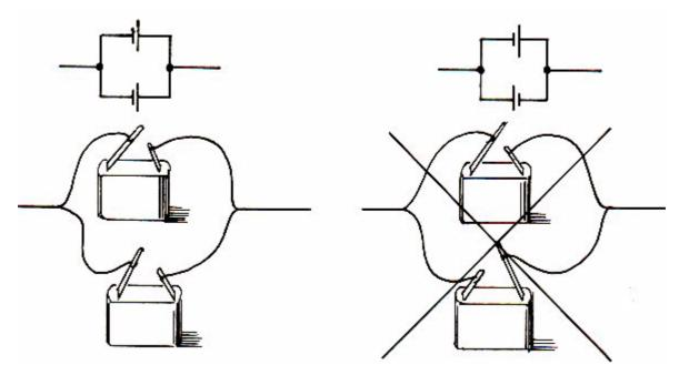
Wir können euch aber nicht empfehlen, beide Formen auszuprobieren, um die auftretenden Unterschiede festzustellen. Bei einer der beiden Schaltungen würden die Batterien sehr schnell zerstört werden.
