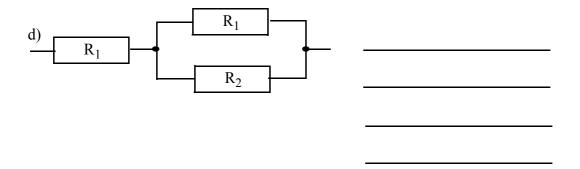
Hinweis: Bei der Teilaufgabe (d) muß man zuerst den Gesamtwiderstand der beiden Parallelwiderstände und danach den Gesamtwiderstand der Reihenschaltung berechnen.
