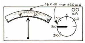
Zeichnet bei den abgebildeten Meßinstrumenten ein, wie der Zeiger und der Wahlbereichsschalter stehen müssen, um den angegebenen Wert zu messen.
