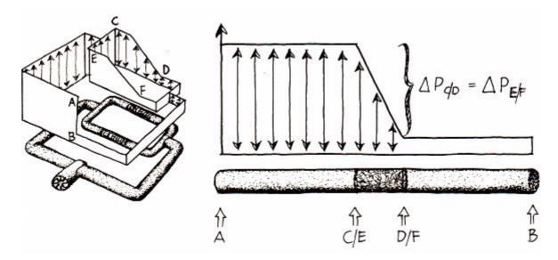
Zunächst gilt, daß der Druck in einem dicken Wasserrohr praktisch überall gleich groß ist.
