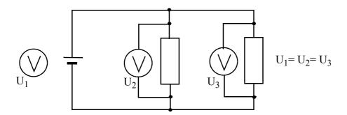
Dieses Regel gilt in gleicher Form für den Druckunterschied in einem entsprechenden Wasserkreis.
