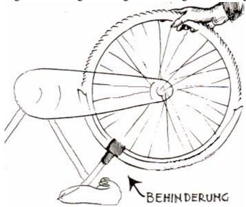
Die Folge dieses Gleichgewichtes zwischen Antrieb und Behinderung ist eine bestimmte gleichmäßige Drehbewegung.
