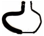
Auf dieser Abbildung wird der Druck direkt durch die Ausdehnung des Schlauches angezeigt, und es wird deutlich, daß unmittelbar vor einem Widerstand kein besonders hoher Druck vorhanden ist. Anhand dieser Abbildung sollte es gelingen, die Frage nach dem Druckverlauf vor,
