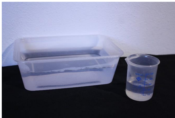
Abbildung 13: Plastikgefäß mit 500 ml Wasser und kleinem Messbecher als Versuchsaufbau für jede Schülergruppe.
