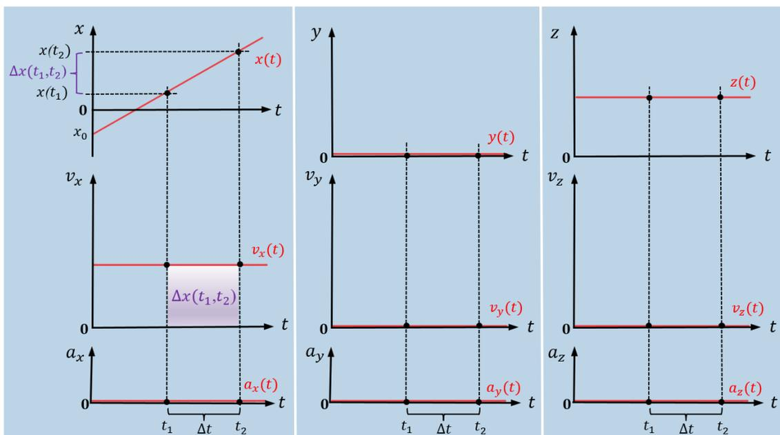
Abb. 11: Diagramme einer gleichförmigen Bewegung in  $x$ -Richtung
