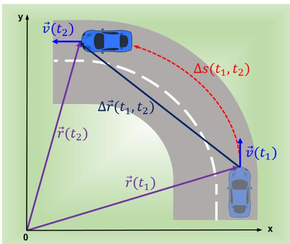
Ein Auto durchfährt in  $\Delta t = 4$  s eine Kurve mit konstantem Tachowert (Tempo) entlang der rot gestrichelten Linie und legt dabei einen Weg  $\Delta s(t_1, t_2)$  von 60 m zurück.
